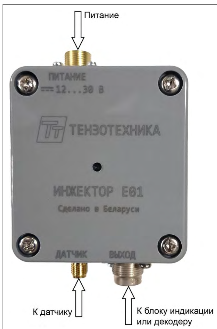
Рис. 2 – Внешний вид инжектора Е01
